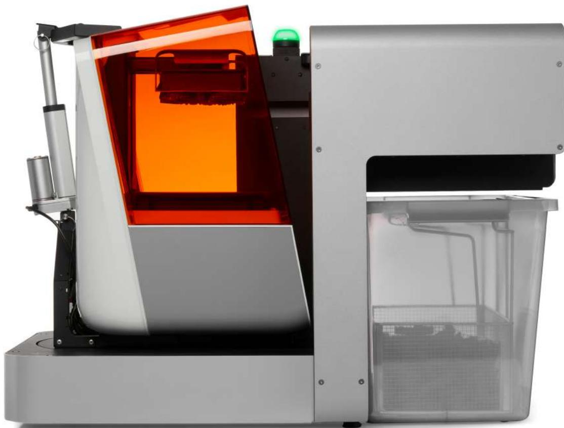
Form Auto（フォームオート）は、プリントが終わった造形品を自動的にBuild Platform 2（ビルドプラットフォーム2）から取り外し、次のプリントを自動的に開始する機械です。
